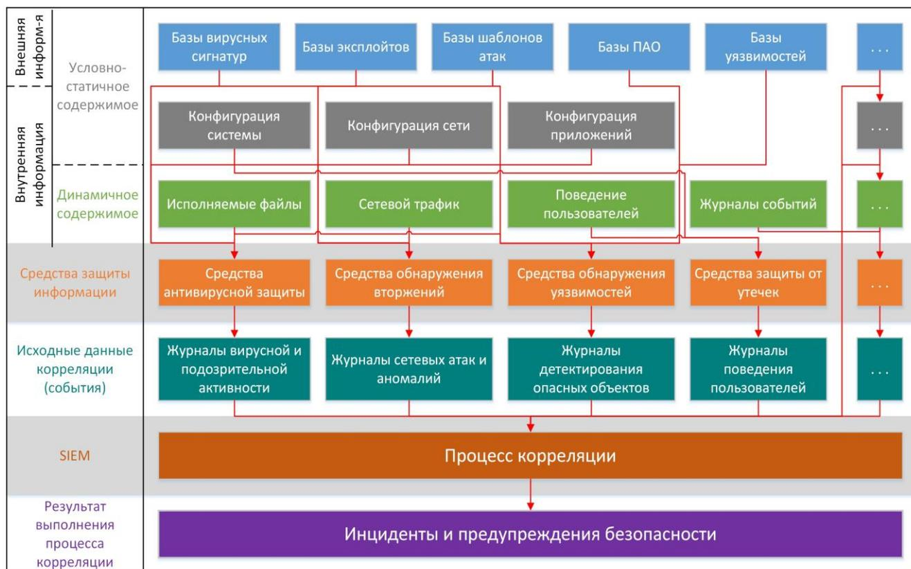
Рисунок 5 - Общая схема использования входных данных для процесса корреляции в SIEM-системах
